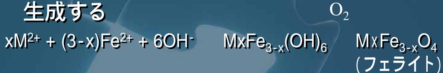
生成したフェライトスラッジは、水に溶解しにくい強磁性体で磁気分離法によって効率的に分離できる
